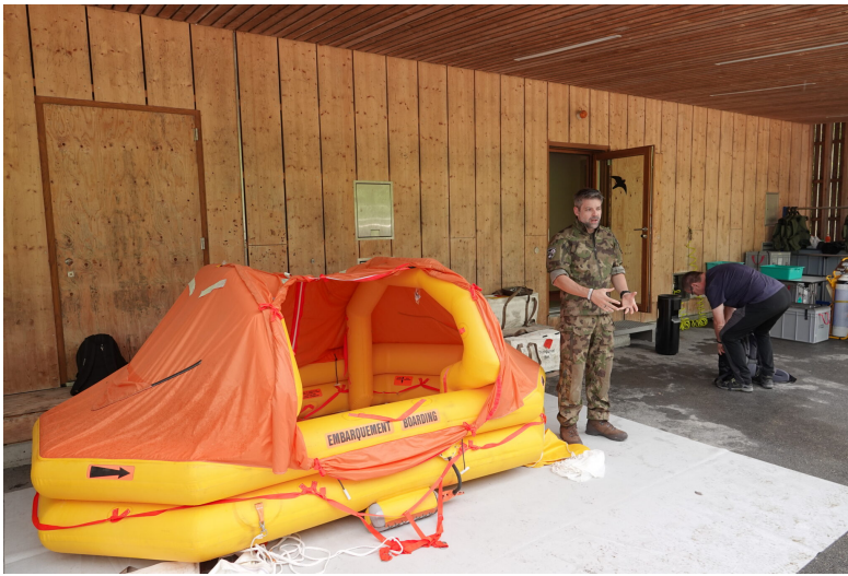
Das Dingi für Militärhelikopter enthält unter anderem einen Wasserfilter, mit dem man Meerwasser zu Trinkwasser verwandeln kann. Das ist besonders wichtig bei Auslandseinsätzen.
