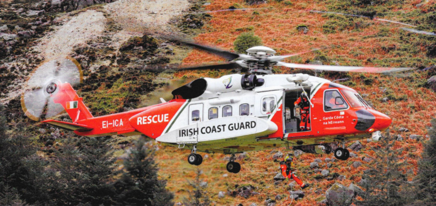
Windemann Colm Blackburn seilt in den südlich von Dublin gelegenen Wicklow Bergen Rettungsschwimmer Alan Callagher ab. Die S-92A sind mit zwei Rettungswinden ausgerüstet.
