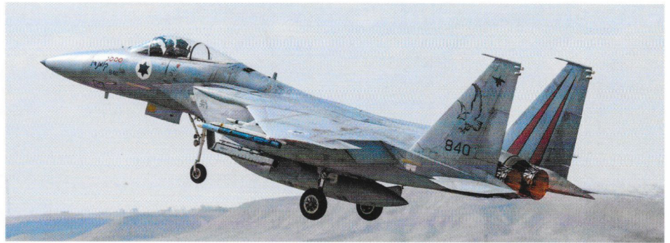
Bei der «840» handelt es sich um eine F-15C der Squadron 106 aus Tel Nof. Gut sichtbar ist der viereckige IAI/Elta EL/L-8222-Pod zur elektronischen Kriegsführung. Die Israelis rüsten ihre Kampfflugzeuge fast ausnahmslos mit einheimischer Avionik aus.
