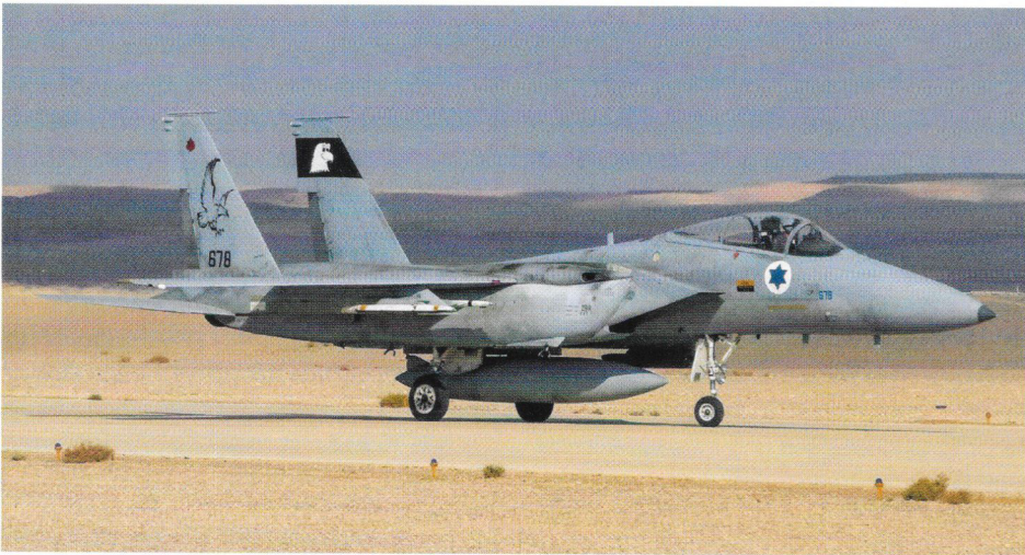
Die israelische Luftwaffe übernahm ab 1976 rund 80 F-15 Eagle der Versionen A/B/C/D/I und setzt diese als Luftüberlegenheits- und Abfangjäger ein. Diese F-15D gehört zur Squadron 133 in Tel Nof und wurde nachträglich mit «Conformal Fuel Tanks» ausgerüstet, seitlich an den Lufteinlässen angebrachten Zusatztanks.
