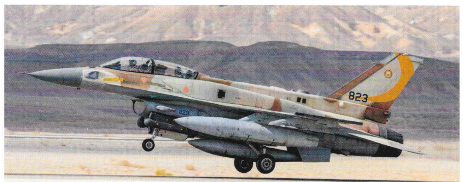
Die israelische Luftwaffe verleiht nicht nur ihren Flugzeugtypen, sondern sogar den einzelnen Versionen hebräische Namen. Diese F-16I Sufa (Sturm) ist normalerweise in Hatzorim stationiert und der 107. Staffel zugeteilt. Am Lufteinlass ist links ein Rafael Litening-Laser-Pod montiert, während auf der rechten Seite ein RecceLite-Aufklärer-Pod angebracht ist.
