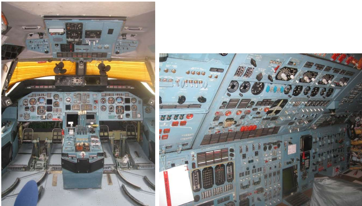
Analoge Avionics im Cockpit und für die Überwachung der vier gigantischen Triebwerke der Antonov 124
