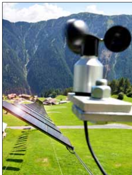
Ein ausgeklügeltes Überwachungssystem für Wind und Schnee sorgt dafür, dass die Anlage auch bei schwierigen Witterungsbedingungen einsatzbereit bleibt Fotos: Hansjörg Egger
