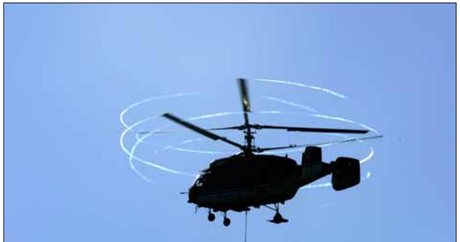
Durch seinen Doppelrotor schwebt der Kamov sehr stabil und bietet genügend Sicherheitsreserven
